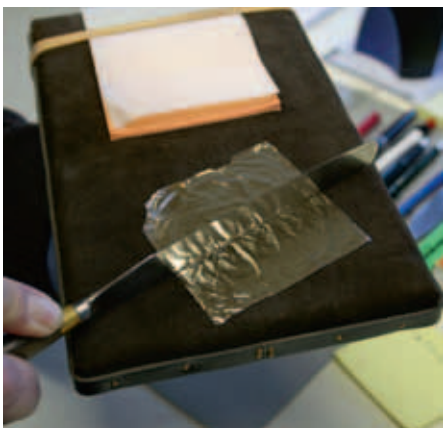
Bladgoud wordt uit het boekje gelicht met het goudmes, gesneden en met een “petit gris” opgepakt om aangebracht te worden op het werkstuk.
