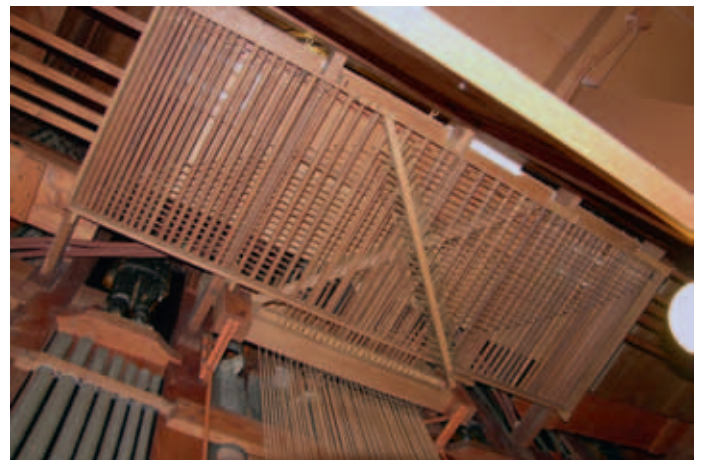
Het wellenraam van het bovenwerk. De speelmechaniek van het hoofd- en bovenwerk gaat niet via traditionele staande wellenborden maar – uitzonderlijk – via grote wellenramen. Hierbij gaat in het midden ervan de tractuur naar de C- en Ciskant via twee rijen winkelhaken die kruislings onder elkaar zijn geplaatst. Links en gedeeltelijk rechts, het onderwerk van twee van de vier gebruinte putti die op de scheidingsslijn tussen hoofd- en bovenwerkfront staan.
