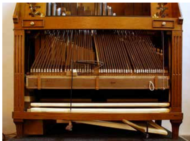
Met afgenomen schot zijn de stekermechaniek en de balgen goed zichtbaar. Links de trede voor de piano-forte, rechts die voor de trapinstallatie.
